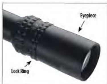
Una volta raggiunta la messa a fuoco ottimale del reticolo, si blocca l'oculare in posizione ruotando la ghiera di tenuta fino al perfetto contatto con l'oculare, mentre si tiene quest'ultimo in posizione. Occorre ruotare la ghiera di tenuta in modo che oculare, ghiera di tenuta e ghiera dello zoom si muovano come un componente unico.
