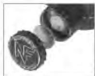
Fig. 6. Sostituzione della batteria.
