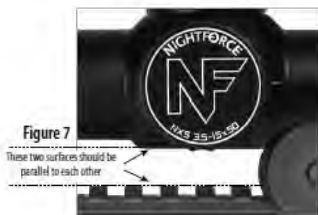
Fig. 7. Le due superfici devono risultare reciprocamente parallele.
